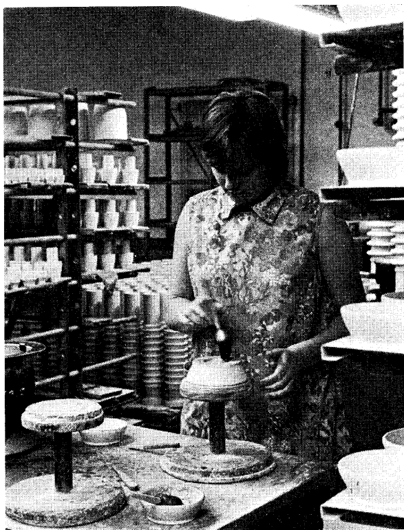
Irena Persson paraffinerar isolatorerna i bägge kortsidor med hjälp av en drejskiva.
